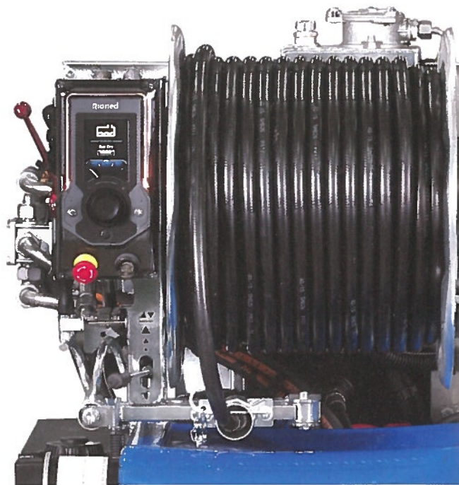
L'AQUAJET(PLUS) PROPOSÉ PAR KÄRCHER, UNE MACHINE SUR CADRE À INSTALLER À L'INTÉRIEUR DES VÉHICULES TYPE CITROËN JUMPY, MERCEDES VITO, VW.
