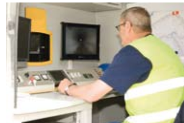
Intérieur d'un véhicule d'inspection télévisuelle
